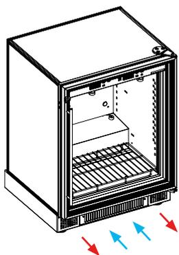
Die Luftflüsse dürfen sich nicht mischen. Sie müssen gewährleisten, dass die neue Luft wirklich von außerhalb kommt, indem Sie die Luftflüsse trennen (zum Beispiel mit Hilfe von angeklebtem Schaumstoff).
