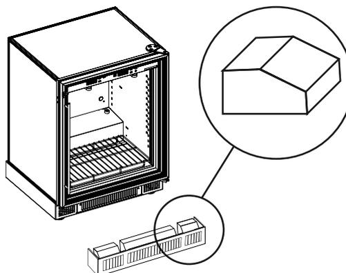
Wenn der Klimaschrank mit Fußverlängerungen installiert wird, um ihn höher zu stellen, ist es wichtig, die Form der Teiler anzupassen, um den (eintretenden oder austretenden) Luftfluss richtig nach unten und somit zum Lüftungsgitter zu leiten.
